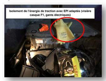
La batterie « accessoire » sera également débranchée afin de finaliser la sécurisation du véhicule.
